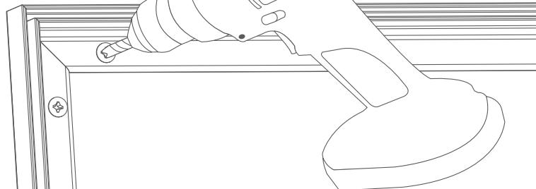
NOTE: THE RX-101 IS SPECIALLY DESIGNED TO CATER FOR UNEVEN & UNSQUARE WALLS, IT IS NOT IMPERATIVE THAT THE MITRE LINES UP PERFECTLY ONLY THE TOP FABRIC CHANNEL ITSELF
